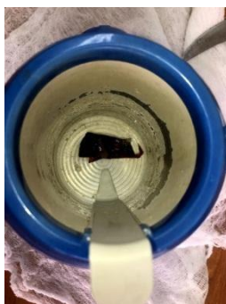
Рисунок 4 - а – биологическая ткань (говяжья печень), помещенная в термостат (модель брюшной полости); б - процесс динамической термометрии в области укладки охлаждающего агента на биологическую ткань, помещенную в термостат
